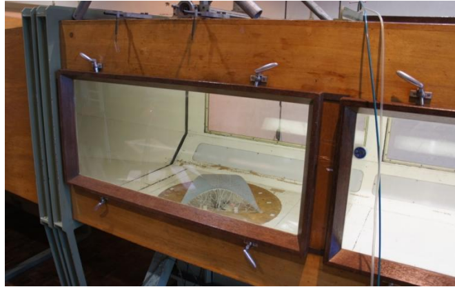
Figura 4-9- Pormenor das janelas laterais existentes no túnel de vento fechado do LNEC
