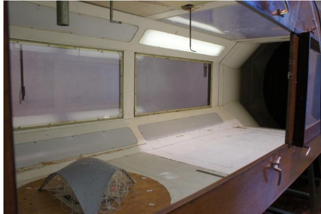
Figura 4-10 Interior do túnel de vento de circuito fechado (LNEC) em que é visível o tubo de Pitot-Prandtl
